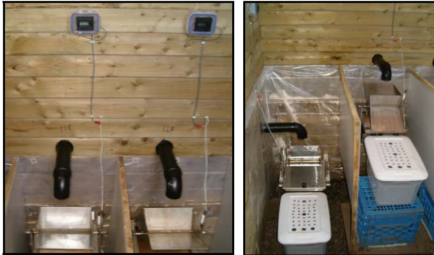
Fig. 4. Augets basculeurs, bacs échantillonneurs et compteurs électroniques dans un cabanon.
