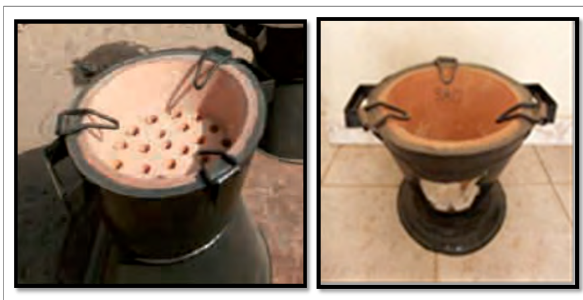
Photo 12 : Fourneaux améliorés utilisés dans les ménages de Koutal pour la réduction des prélèvements de bois de feu dans la jachère forestière améliorée (Photo: PROGERT, 2010)
